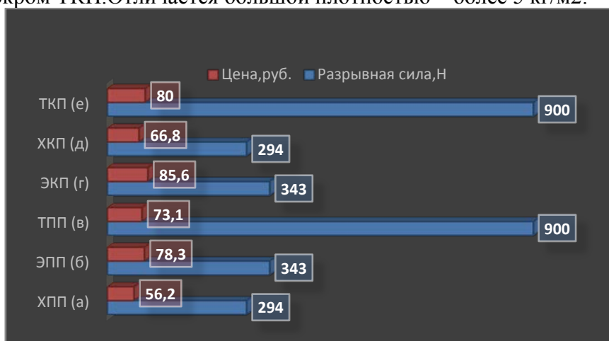
Рисунок 4. Виды линокрома (а- ХПП, б- ЭПП, в- ТПП, г-ЭКП, д- ХКП, е-ТКП)
