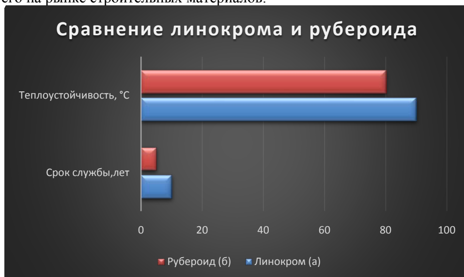
Рисунок 3. Сравнение линокрома и рубероида (а- линокром, б- рубероид)
