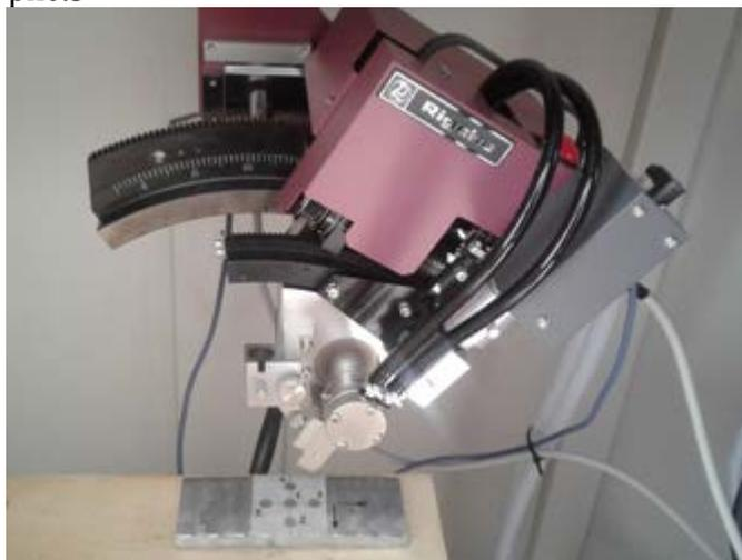
Рис. 3 Фотография гониометра и исследуемого металлоизделия.
