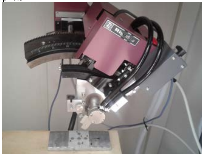
Рис. 3 Фотография гониометра и исследуемого металлоизделия.
