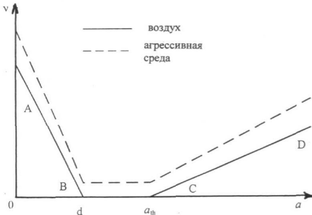
Рис.2. Скорость роста микроструктурно короткой и физически малой усталостной трещины при напряжениях меньше  $\sigma_R$  [11].
